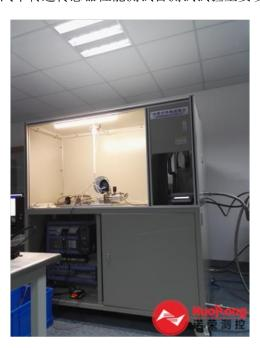
汽车压力传感器性能测试台是一种汽车压力传感器的测试工装,包括底座,在底座上安装有箱体,箱体和底座形成密闭空间,在底座上设有待测试压力传感器的安装结构,在箱体的上设有接气口,测试接插头和温度压力传感器,测试接插头通过线束与待测试压力传感器相连。本实用新型提供了一种结构简单,可以通过控制不同的压力和温度来模拟各种海拔的效果,提前排查压力传感器可能出现的问题,保证压待检测压力传感器性能的汽车压力传感器的测试工装;解决了现有技术中存在的测试工装体积大,结构复杂,只能模拟气压变化,
